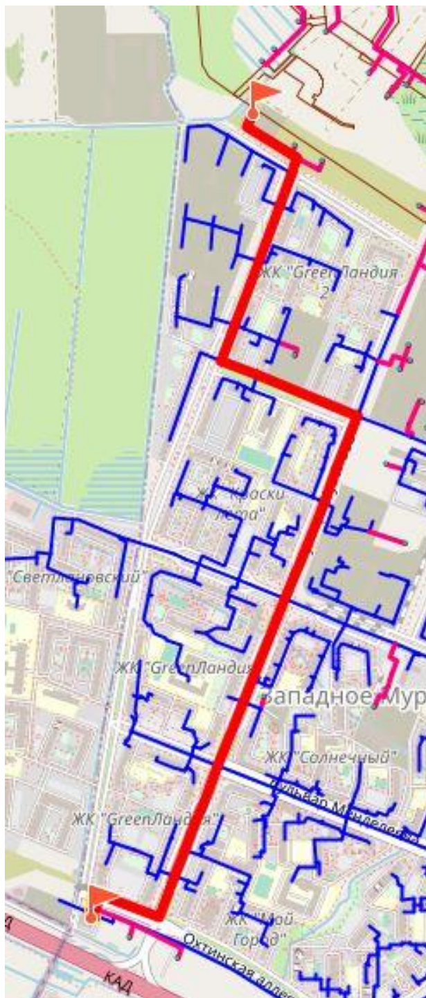
Рисунок 25. Путь для построения пьезометрического графика от котельной ООО «Петербургтеплоэнерго» до перспективного потребителя Отделение полиции
